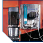
Solution liquide de barrage pour garniture dos-à-dos
